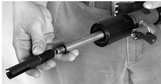
Fixez l'écrou d'accouplement à l'emporte-pièce.
